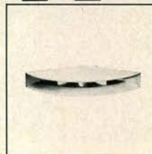
M 300: Geheel nieuw ontwikkelde exponentiële hoorn. Het frekwentieverloop is absoluut konstant van 3000 Hz - 12000 Hz. Tot een stralingshoek van 120°. Resonantie vrije opbouw uit MDF-materiaal.
